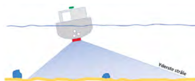
Illustrationen viser, hvordan et MultiBeam ekkolod kan kompensere for skibets rulninger i søen og en gyro måler retningen af ekkolods-fanen.
