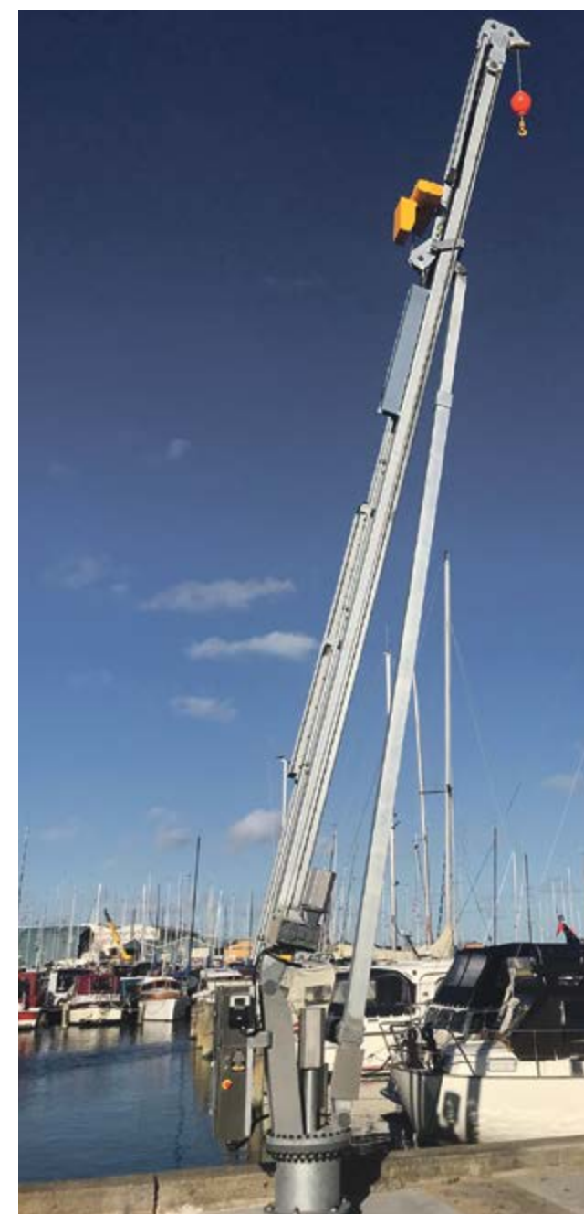
Mastekranen nederst fås i tre størrelser med forskellig løfteevne og højde. 500 kg, 1600 kg og 2500 kg. Sidstnævnte har en standardhøjde på 15 meter.
