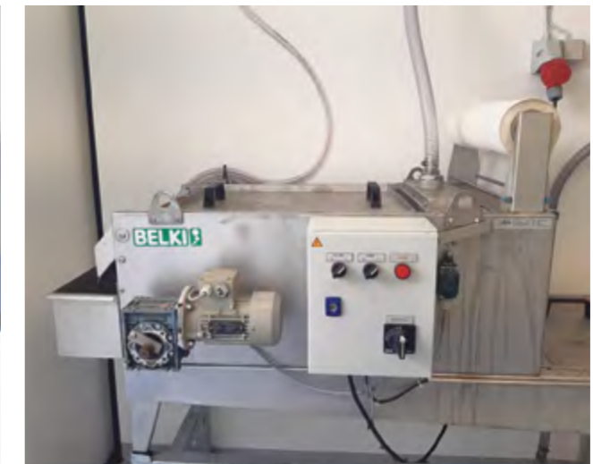
Vandet løber først gennem båndfilteret, som frasorterer partikler ned til 50 my.
