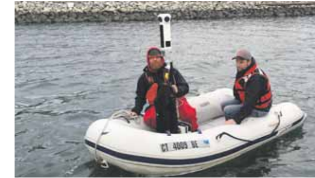
Inspektion med CPV-kamera monteret på rygsæk.
