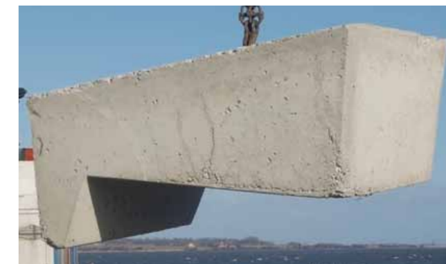
Sådan et plov-anker vejer over 2 ton.
