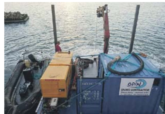
Arbejdsprammen er 6 x 6 meter og stikker kun 30 cm, så den kan komme ind de fleste steder. Foto: Odin Diving
