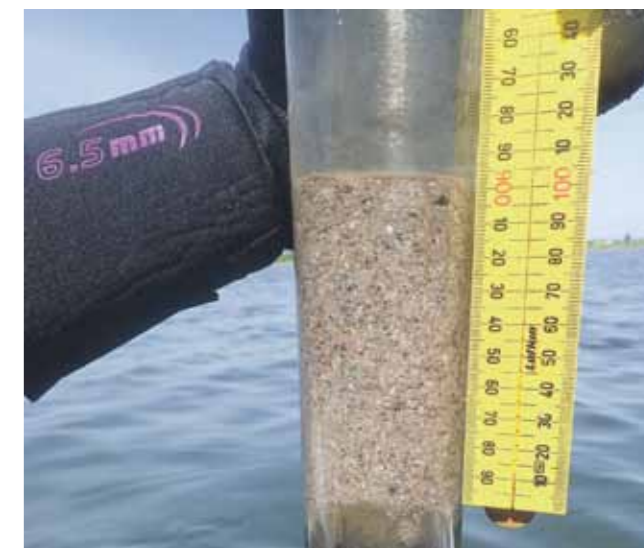
I forsøget måles sandlagstykkelsen med sedimentkerner.
